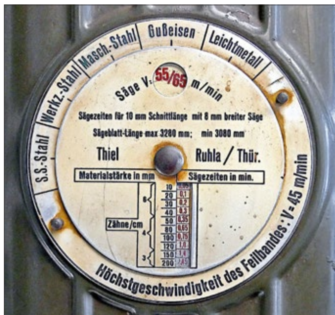
Rechenscheibe zur Ermittlung der richtigen Einstellungen für unterschiedliche Materialien
