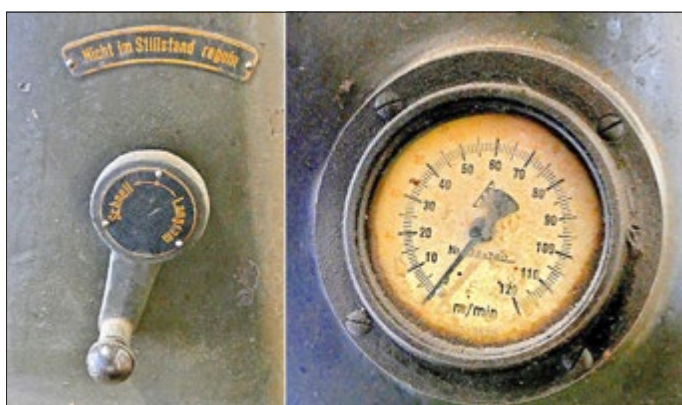
Stellhebel und Anzeige für die Geschwindigkeit in Meter pro Minute
