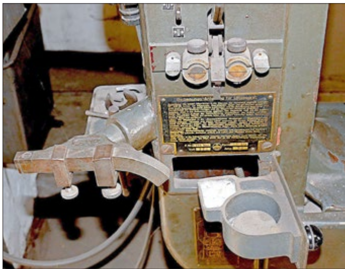
Lötapparat zum Verbinden der Sägebandenden
