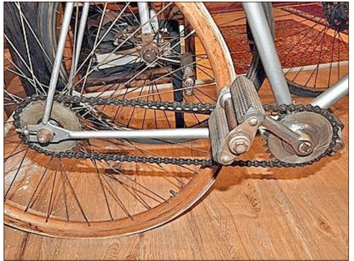
Keine Gangschaltung, kein Freilauf oder Rücktritt. Die Übersetzung erfolgt direkt mit gleichgroßen Zahnradern.
