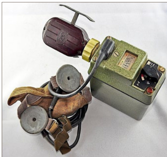
Kernstrahlungsmessgerät RSA-64D mit „Taschenlampenantrieb“
