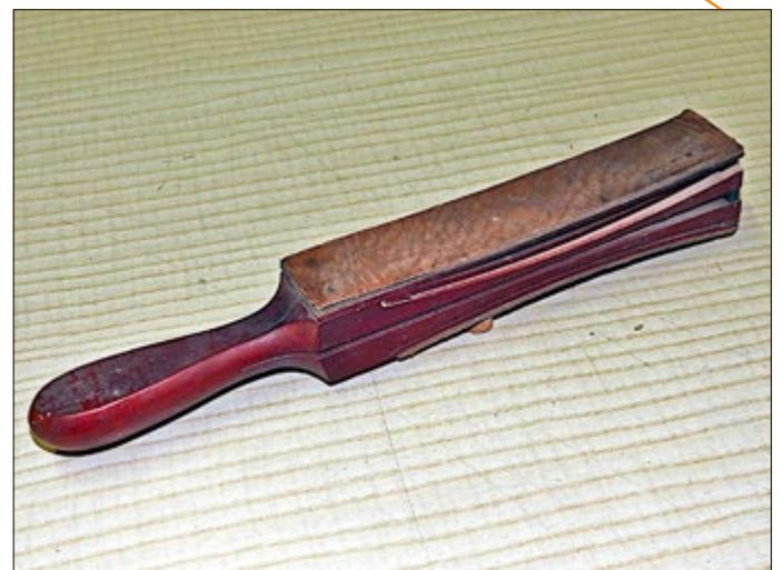
Gerät zum Abziehen bzw. Schärfen des Rasiermessers
