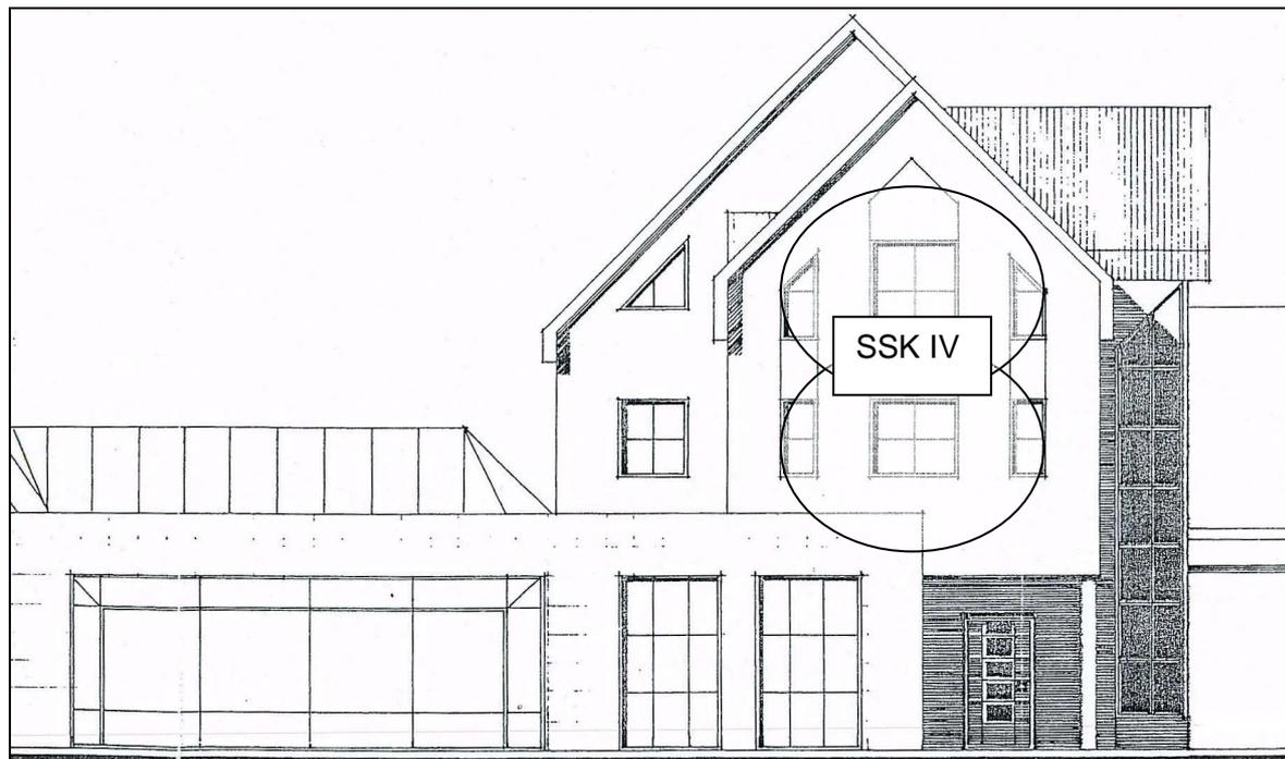
Ostfassade mit markierten Fenster der SSK II, die durch Fenster der SSK IV zu ersetzen sind.
