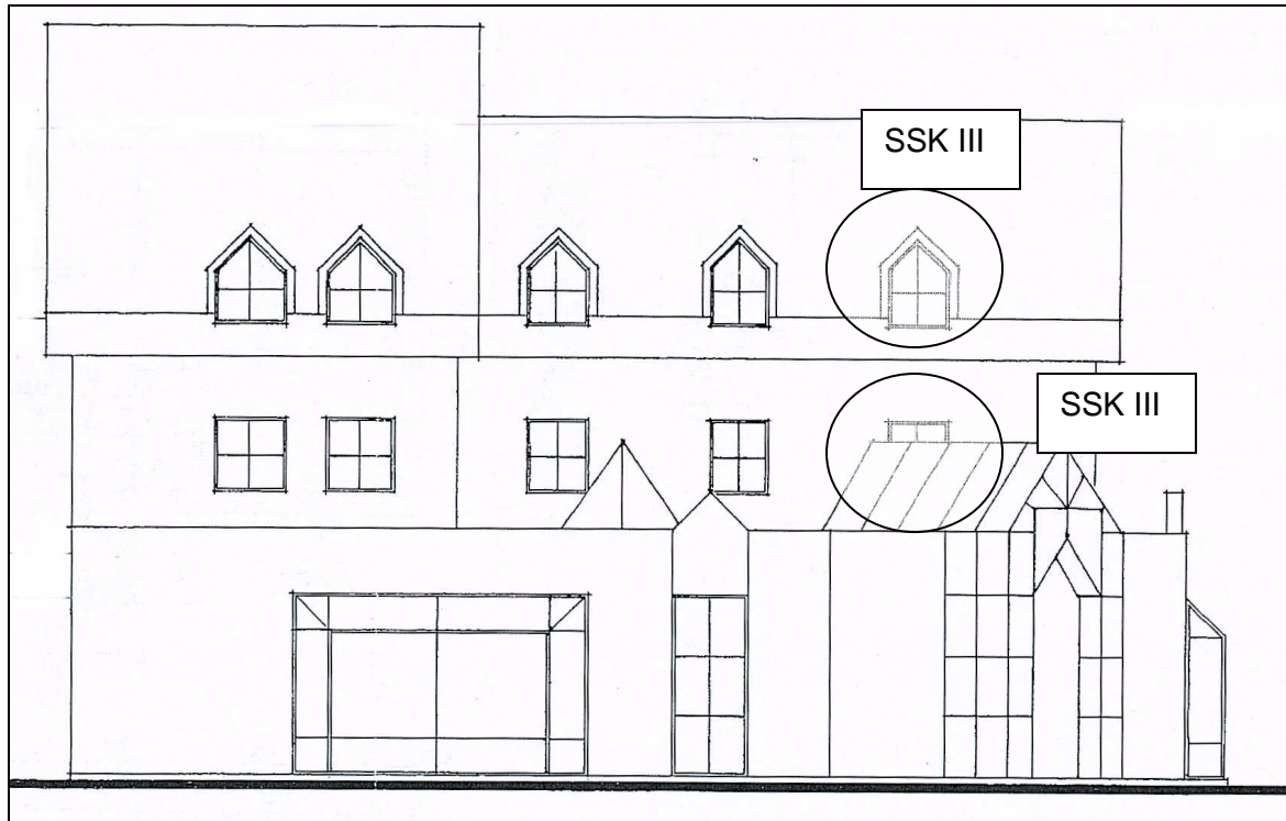
Südfassade mit markierten Fenster der SSK II, die durch Fenster der SSK III zu ersetzen sind.
