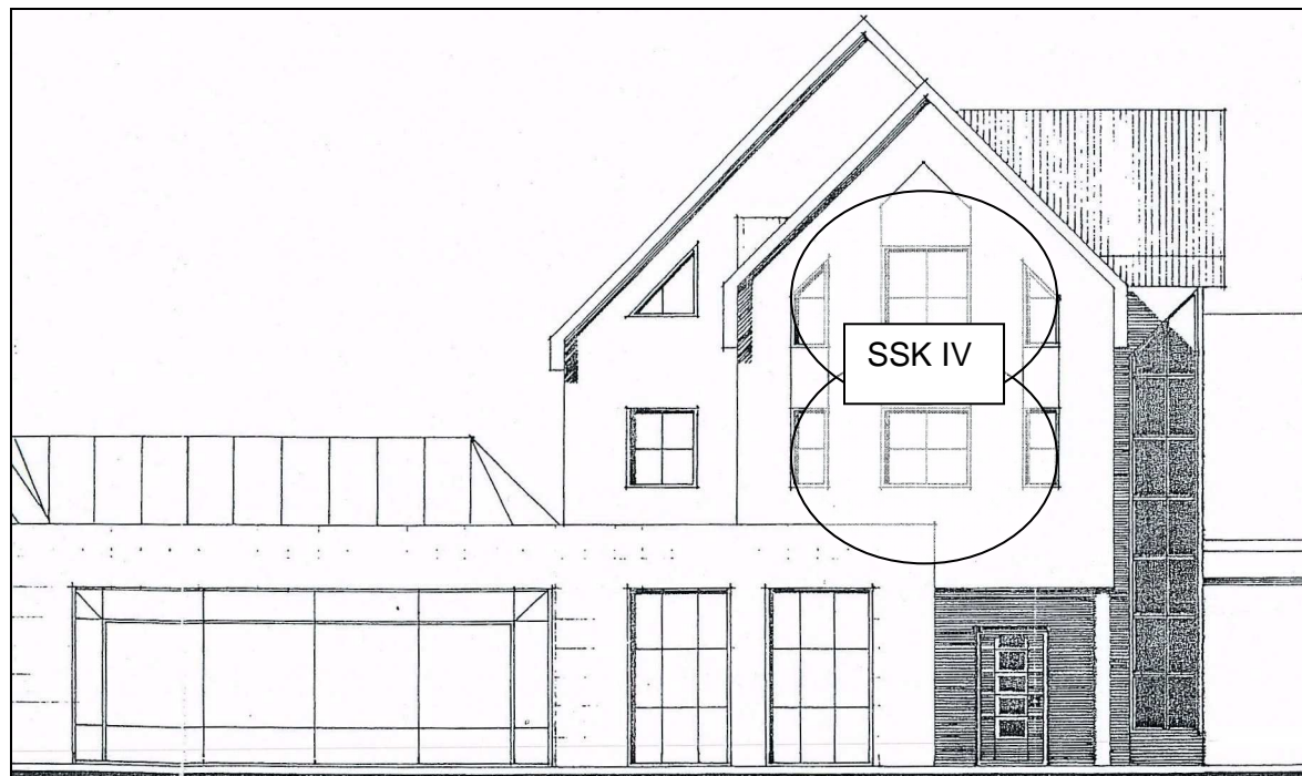
Ostfassade mit markierten Fenster der SSK II, die durch Fenster der SSK IV zu ersetzen sind.
